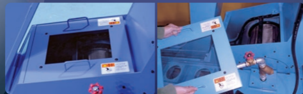
二段式ドラム点検用窓 窓蓋の取り外しが容易でメンテナンス性に優れています。
